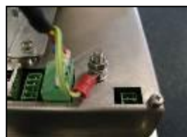
7) Connect MEC sensor earth to earth stud
