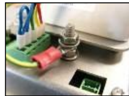
11) Connect MEC sensor earth to earth stud
